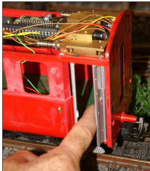
Quetschgefahr aus-geschlossen, hier demonstriert der Entwickler die Rutschkupplung seiner neuen Technik. Gut im Bild erkennbar die massive und aufwendige Mechanik in Frästechnik mit integrierten Motoren und Getrieben. Links davon der neue Spezialdecoder der Fa. Massoth.
