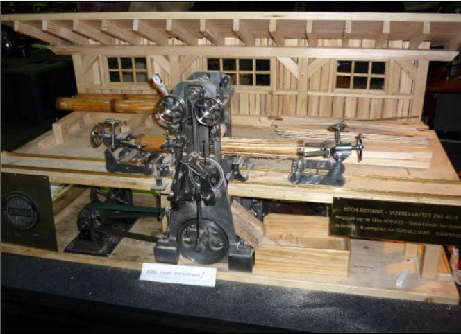
Ein voll funktionsfähiges Modell einer Hochleistungs-Schnellgattersäge Typ: Herkules ZVG65H, welche auch gut zur WSL&RS Logging Railroad passen würde, gebaut von B. Meinel.
