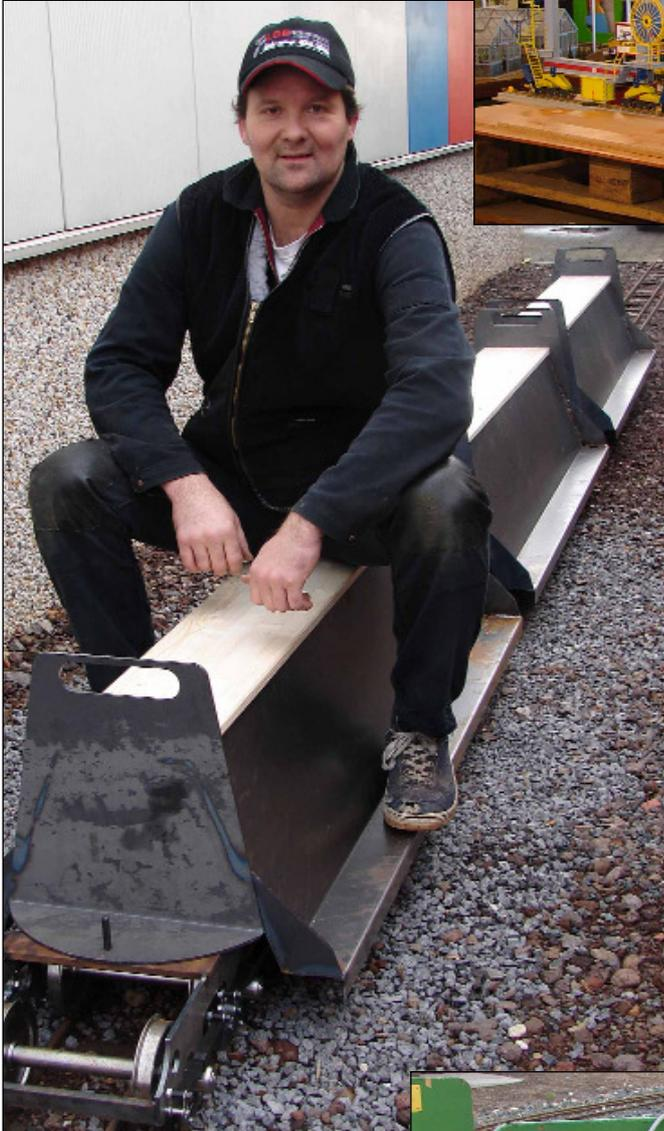
Durch die Verwendung von gefederten Jakobs-Drehgestellen zwischen den Fahrzeugen sowie der Überlappung der Fahrzeugschalen auf diesen Drehgestellen, konnte die Kippsicherheit nochmals erheblich gesteigert werden.
