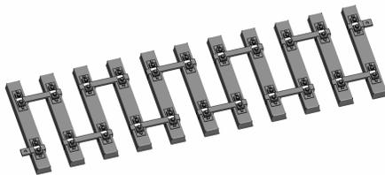
An den Enden ist die Anschlusslasche mit 15mm Länge so gewählt, dass sich mehrere Flexgleisschwellenbänder einfach hintereinander legen lassen und der Schwellenabstand gleichbleibend ist. Es besteht die Möglichkeit, die eingeschobenen Messingprofile von unten durch die Anschlusslaschen mit einer M2 Schraube zu verschrauben.
